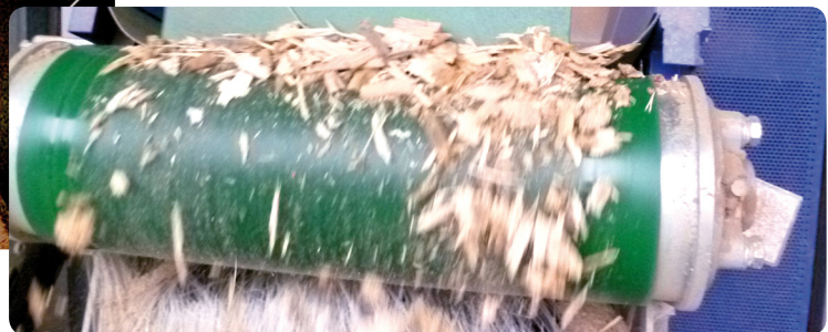
Ein Förderband transportiert die auf Maß gehäckselten Holzhackschnitzel in das Silo.
