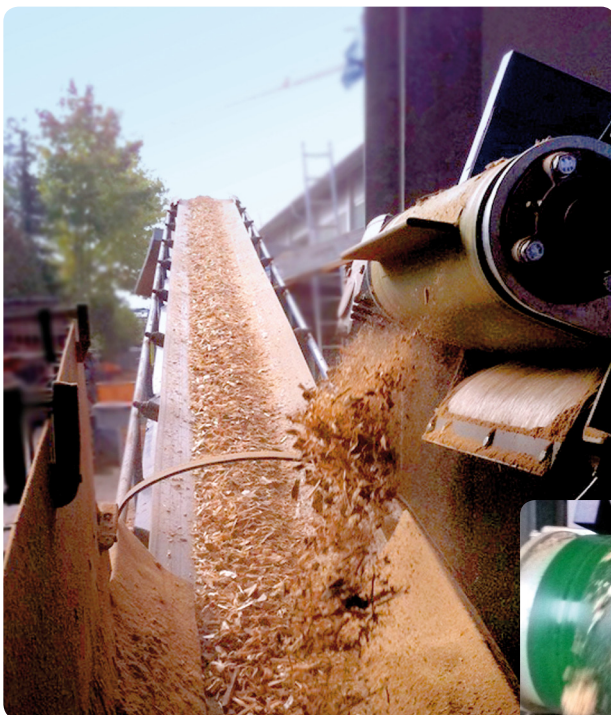
Ein Förderband transportiert die auf Maß gehäckselten Holzhackschnitzel in das Silo.
